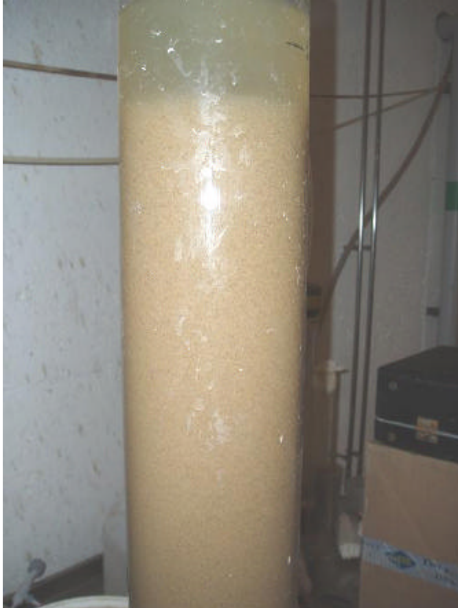
Figur 5. Flockbildning i vattenkolumnen ovanför sandbädden.
