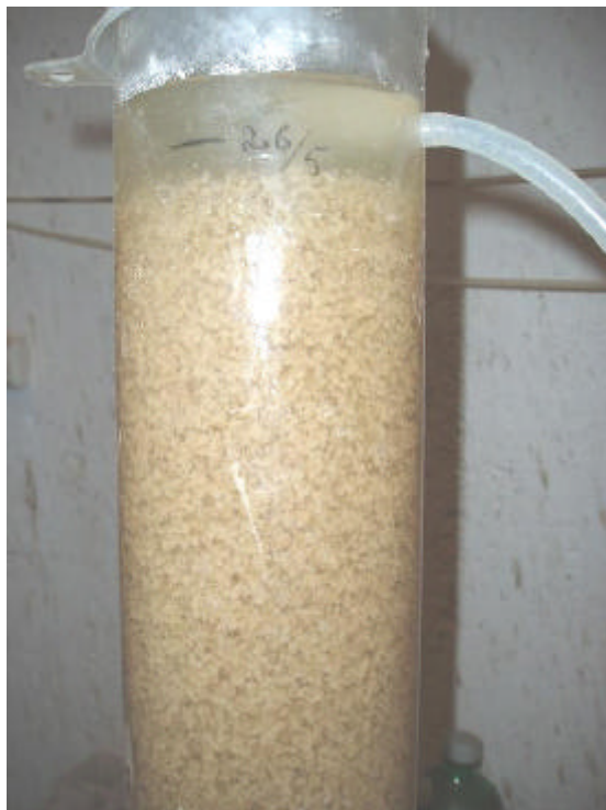
Figur 4. Flockbildning i vattenkolumnen ovanför sandbädden.
